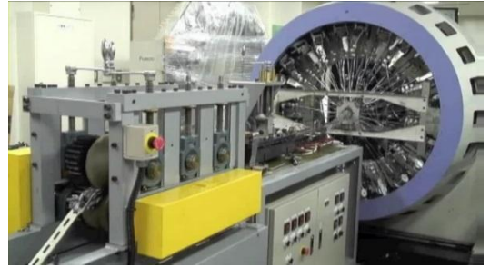
自在な力学特性の複合材が製造できる組紐装置
